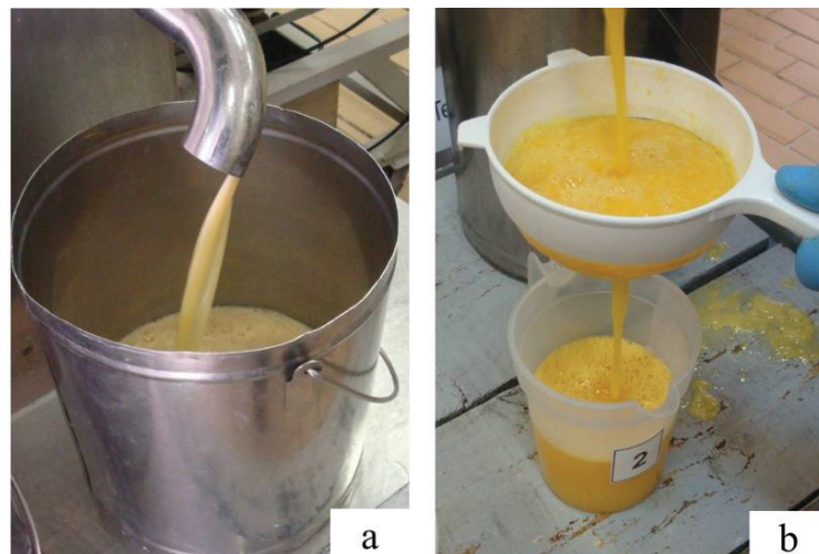
Figura 5. Obtenção do suco de laranja no balanço de massa. Obtenção de suco (a), filtragem manual do suco extraído (b) para separar o suco da polpa, simulando o processo de finisher .
