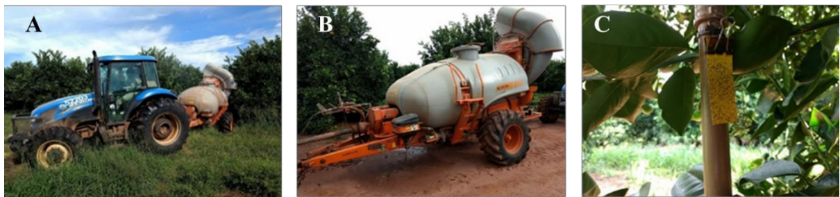
Figura 4. Equipamentos utilizados para a aplicação dos tratamentos e aferição da cobertura de calda aplicada. A) Trator NH 5 TL 75 (New Holland Industrial Latin América Ltda., Curitiba/PR). B) Turbopulverizador Arbus 4000 L (Máquinas Agrícolas Jacto S.A., Pompéia/SP) com defletor unilateral. C) Papel hidrossensível colocado junto ao tronco das plantas para medir a cobertura da calda aplicada no interior da copa da planta.
