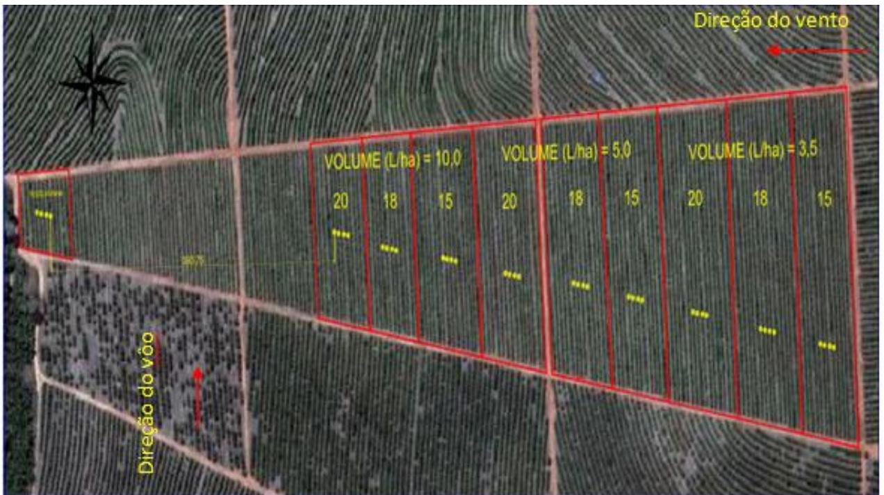
**Figura 2.** Croqui da área do segundo experimento (\* 20; 18 e 15 representam as diferentes faixas de aplicação em metros). Pontos em amarelo representam as plantas onde foram realizados os confinamentos.
