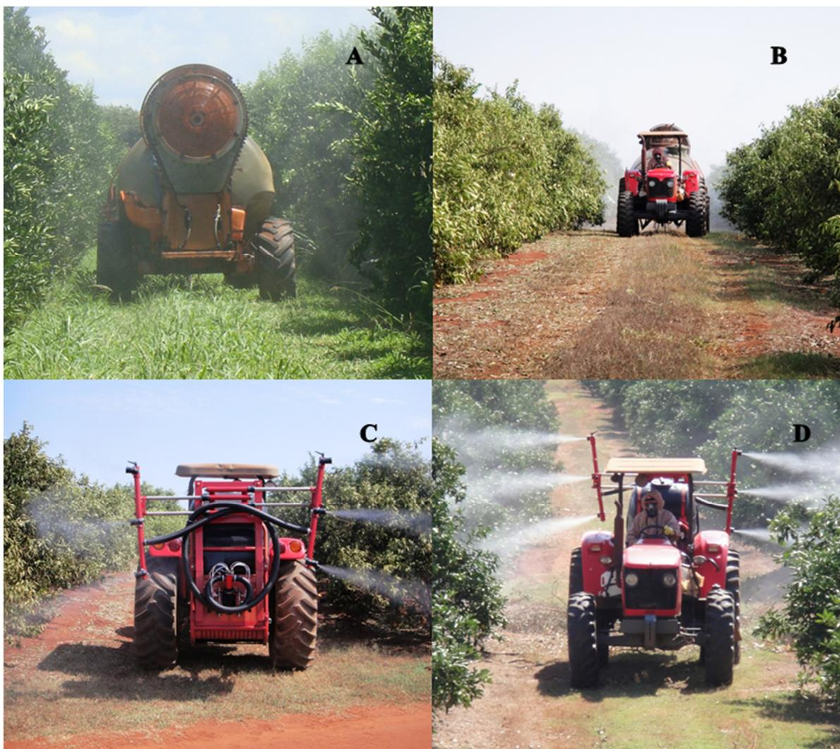
**Figura 1.** Pulverizador Arbus Jacto® Valencia 2000 (A e B) e Pulsfog Smart® 400UBV (C e D) durante aplicação de inseticidas.
