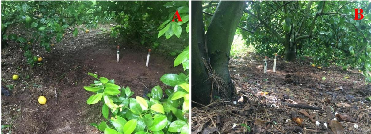
**Figura 8.** Tensiômetros instalados na linha de plantio às profundidades de 20 e 40 cm da área experimental de limão-siciliano (variedade ‘Limoeira 8A’ enxertada em citrumeleiro ‘Swingle’) visando avaliar a influência da poda na dinâmica e intensidade de brotação em plantas saudáveis e afetadas por HLB.
