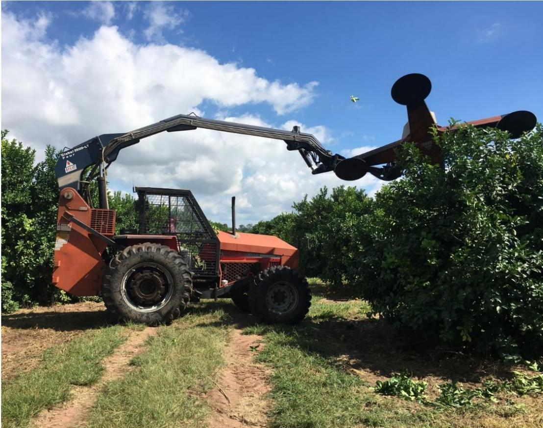
**Figura 6.** Conjunto de máquina de poda de discos circulares, constituído por podadeira IFLÓ Global 3500 LT FOUR acoplada em trator de 95 cv, realizando poda em topo de planta experimental de limão-siciliano (variedade ‘Limoeira 8A’ enxertada em citrumeleiro ‘Swingle’) visando avaliar a influência da poda na dinâmica e intensidade de brotação em plantas saudas e afetadas por HLB.
