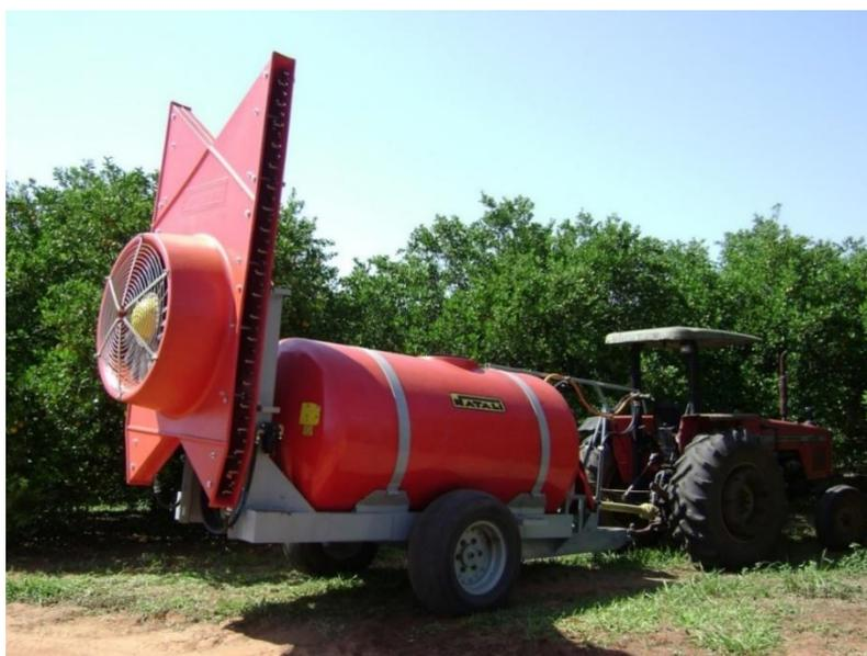
**Figura 3.** Turbopulverizador tracionado bilateral (Alfa 4000, Natali, Limeira/SP) utilizado na aplicação dos inseticidas no experimento.
