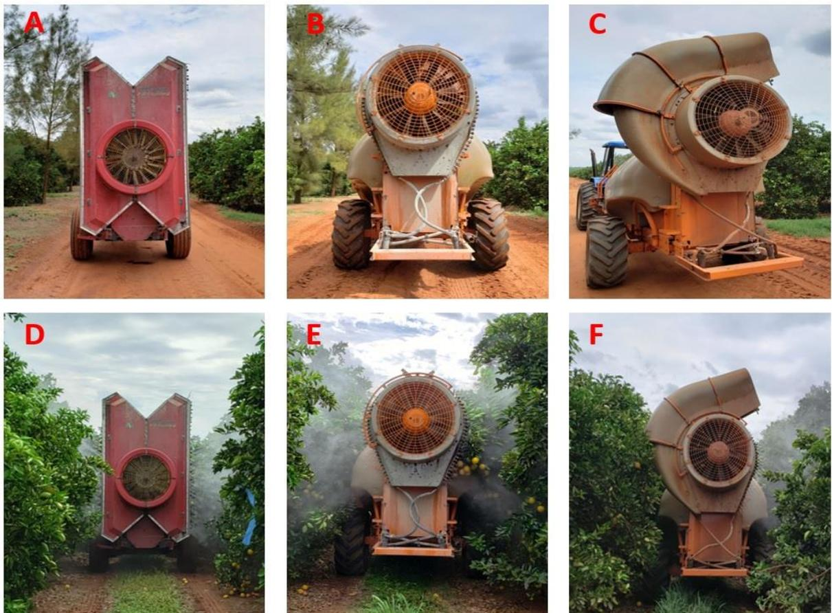
**Figura 1.** Turbopulverizadores de arrasto tratorizados com assistência de ar (A-C) e aspecto da pulverização da calda acaricida por cada equipamento (D-F). Tratamento 1 - Turbopulverizador FMCopling® Guliver 4000, em pulverização bilateral (A e D), Tratamento 2 - Turbopulverizador Jacto® Arbus Valência 4000, em pulverização bilateral (B e E) e Tratamento 3 - Turbopulverizador Jacto® Arbus Valência 4000, em pulverização unilateral com a montagem de defletor do tipo voluta (C e F).
