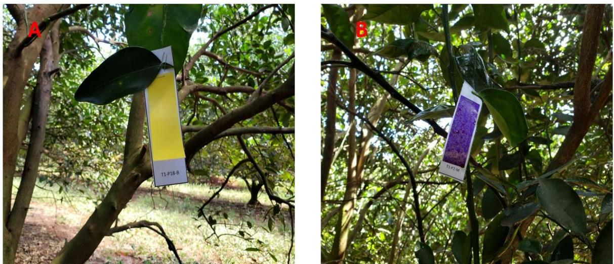
**Figura 6.** Experimento para avaliação da mortalidade de ácaros em folhas destacadas e pulverizadas com acaricida. A) Posicionamento das folhas sem resíduos de agrotóxicos, juntamente com o papel hidrossensível no interior da planta. B) Papel hidrossensível e folha destacada após a pulverização pelos equipamentos.
