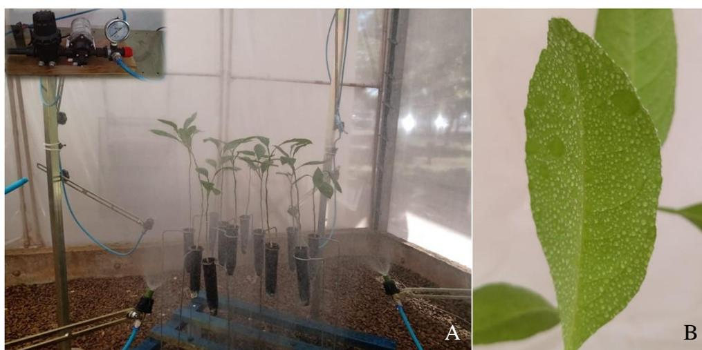
**Figuras 1.** A) Barra pulverizadora estacionária; B) folha pulverizada até próximo ao ponto de escoamento.
