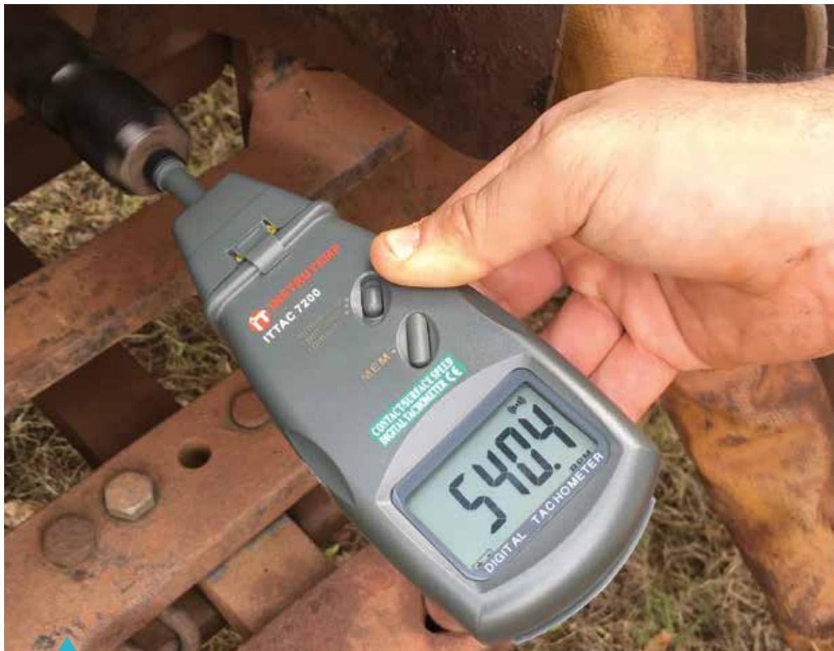
A rotação no motor necessária para proporcionar 540 rpm na TDP é variável entre marcas de tratores e entre modelos de uma mesma marca, por isso, ela está sempre especificada no tacômetro do trator ou nos adesivos de relação de marchas. Apesar disso, a aferição da rotação na TDP do trator é recomendada sempre que possível por meio da utilização de tacômetros, pois com o desgaste do equipamento esta rotação pode ser alterada.
