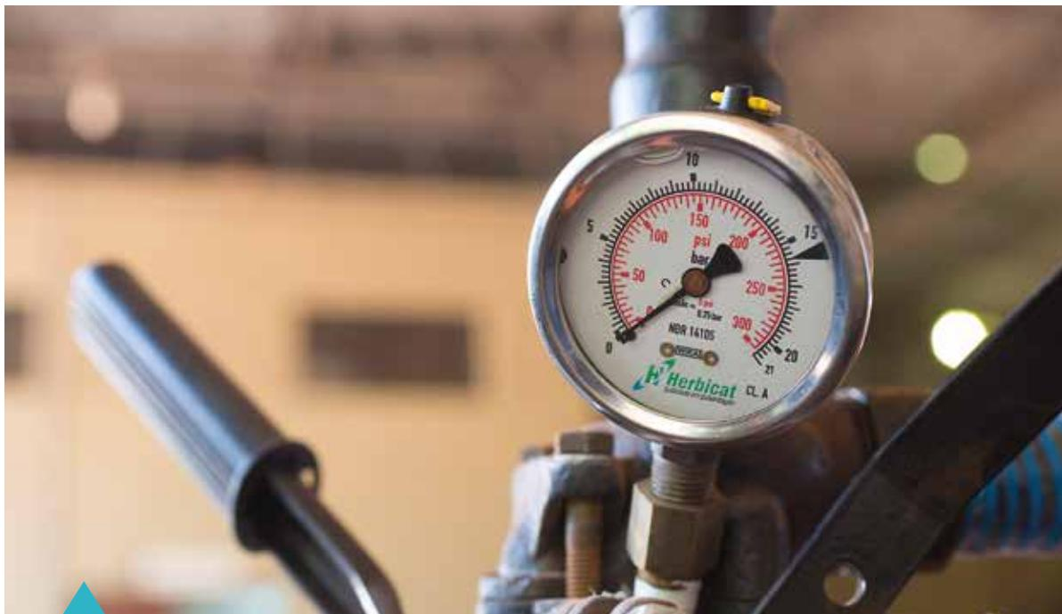
Os manômetros são equipamentos utilizados para aferição da pressão de trabalho do pulverizador. É extremamente importante verificar as condições gerais dos manômetros, como a existência de líquido no interior do mesmo e se o ponteiro está atingindo a posição que marca a pressão zero, caso contrário ele deverá ser substituído. *(Veja foto)*
