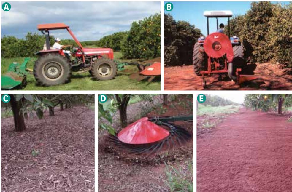
Figura 8.5 Rastelo mecânico na parte frontal do trator para remover as folhas de citros caídas e trincha na parte traseira para triturar as folhas e acelerar sua decomposição (A), sugador (B) e rastelador mecânico de folhas (C-E).
