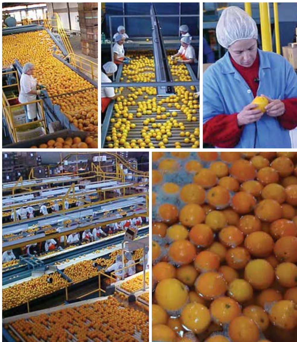
Figura 8.29 Processo de seleção e descarte de frutos sintomáticos no packinghouse por inspetores e posterior tratamento dos frutos em banho em soluções com fungicidas ou ceras.
